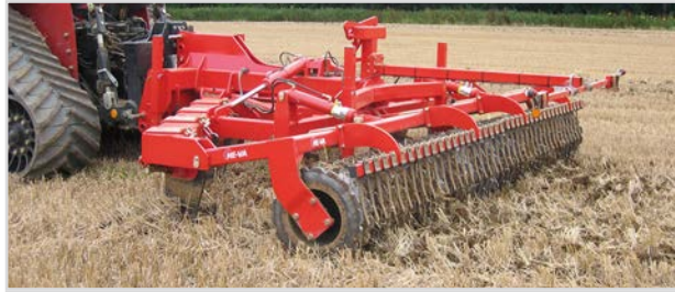
5,00 m Sub-Tiller mit V-Profil-Walze und hydr. Steinsicherung
