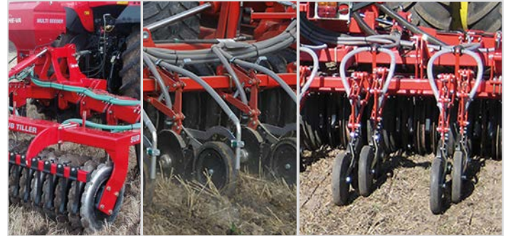
Aussaat mit Scheibenscharen mit 75 mm breitem Tiefenrad / Packerrad. Platziert in einer Reihe pro Zinke nach der Packerwalze.
