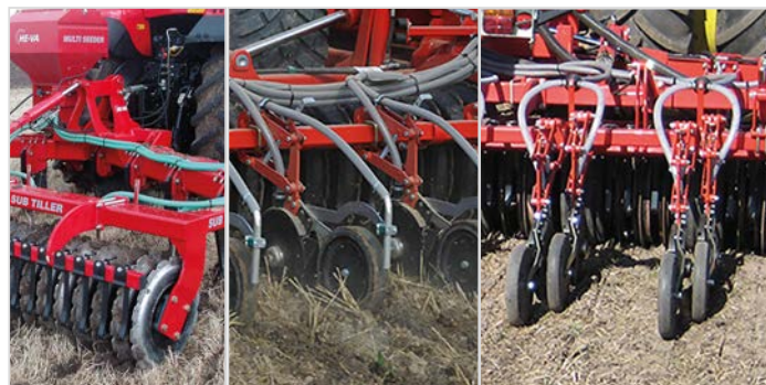
Skivskärssåning (12 cm ml./skivskär) m/ 75 mm breda djuphållningshjul / packhjul. Placerat i 2 rader per pinne. En rad på var sida om avluckningsytan efter packvalsen
