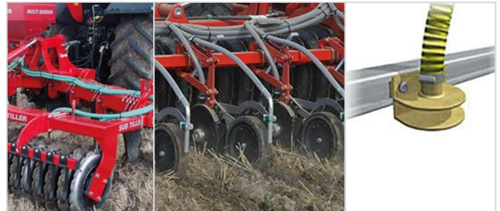
Skiveskærs-såning med 75mm brede dybdehjul / pakkerhjul. Placeret i 1 række pr. tand efter pakkervalse.
