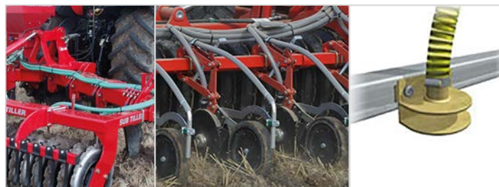
Skivskärssåning med 75 mm breda djuphållningshjul / packhjul. Placerat i 1 rad per pinne efter packvalsen.
