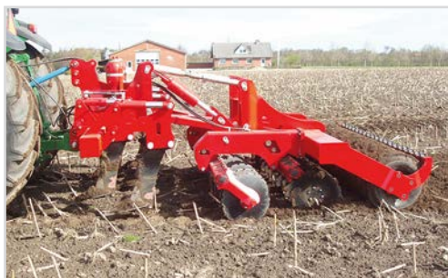
Combi-Disc med alvluckringspinnar lyfta ifrån marken, och därmed är endast Disc-Roller funktionen i arbete.
