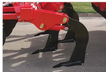
Pinn-design i Combi-Tiller MKII och Combi-Disc.
