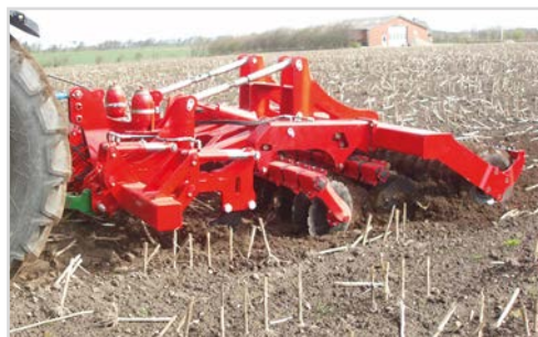
Combi-Disc med alvluckringspinnarna i fullt arbetsdjup. Därmed uppnås alvluckring, kultivering och återpackning.
