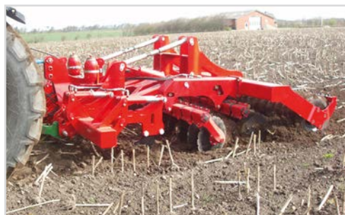
Combi-Disc avec dents à profondeur maximum. Décompactage, déchaumage et retassement combinés.
