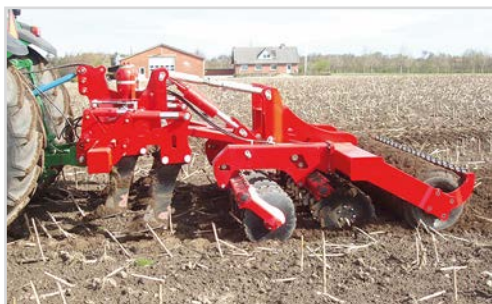
Combi-Disc avec dents relevées. Seule la fonction de déchaumage est employée.
