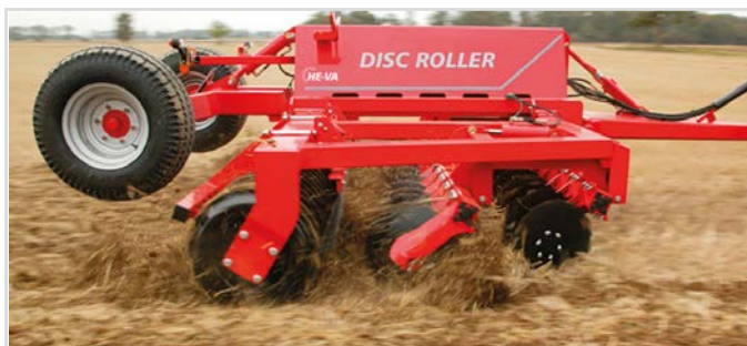
5,00 m avec rouleau V-profil et tablier caoutchouc
