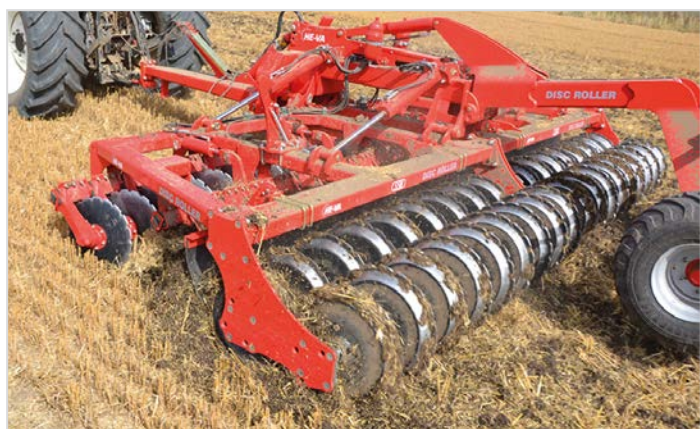
5,50 m Disc-Roller Contour m/Twin V-Profilvals och material-dämpare.
