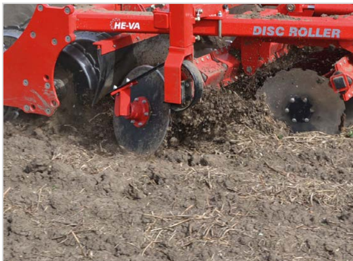
Standardutrustning på alla modeller: Justerbar kantallrik för jämn övergång mellan dragen, höger sida.
