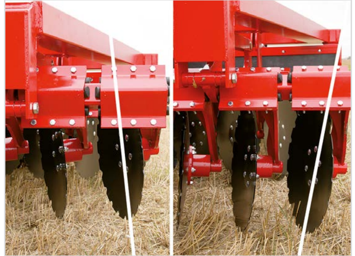
Standard sur tous modèles: "DSD": Technologie synchronisant l'agressivité et la profondeur de travail des disques.
