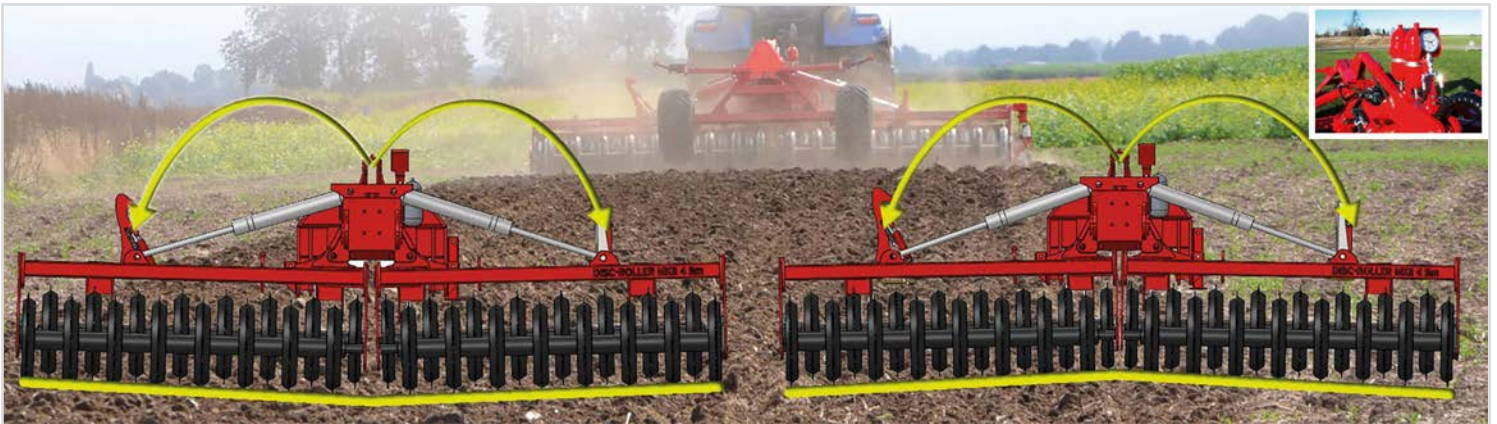
Standard sur modèles 2 et 3 sections: HE-VA Système SAT hydraulique: (Transfert de poids) Ce système hydraulique ajuste et uniformise la pression exercée au sol sur la largeur de travail par le Disc-Roller Contour. Un manomètre permet de vérifier le réglage des boules d'azote.
