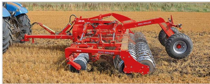
5,50 m Disc-Roller Contour avec rouleau double Twin V-Profil et tablier caoutchouc.
