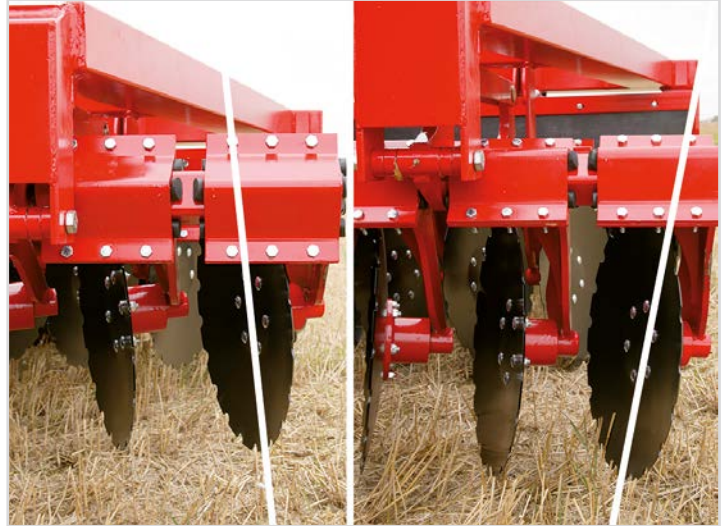
Grundausrüstung an allen Modellen: "DSD": „Depth Synchronized Disc“-Aggressivität.
