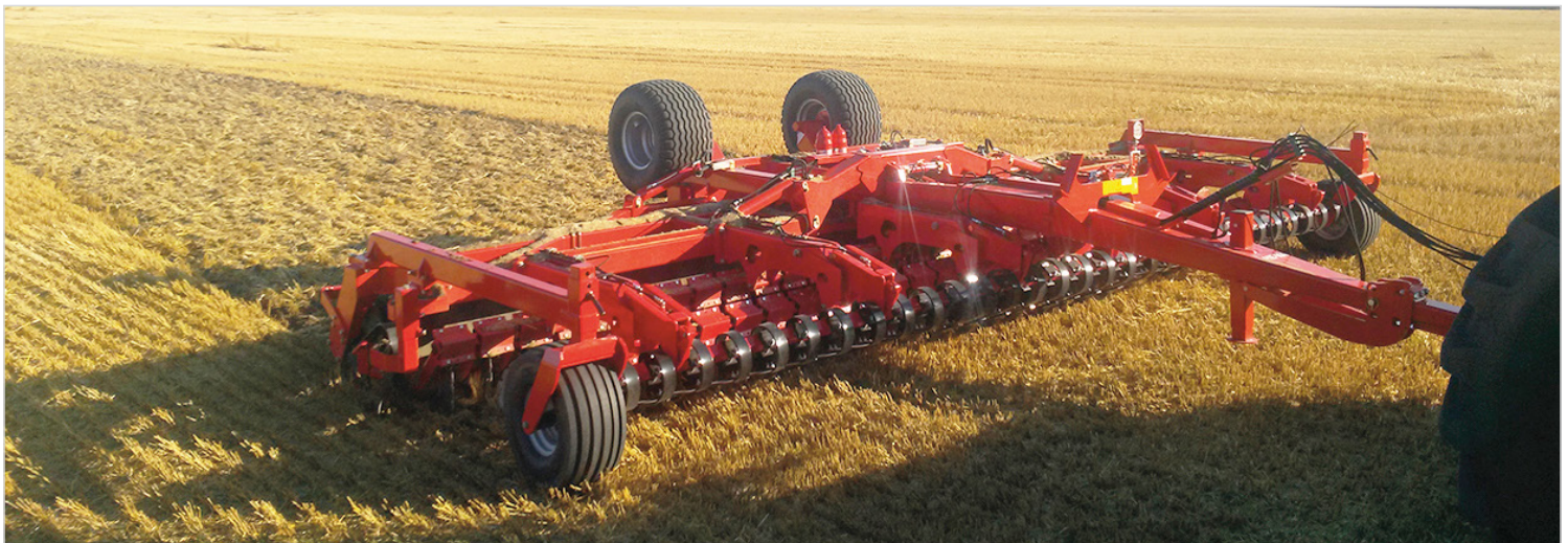
6,50 m Disc-Roller Contour Spritz Tuch für das Material, drehbaren Stützrädern und Pendelzug.
