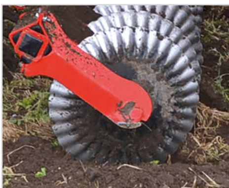
Ø570x6 mm profileret opblandingsdisc
