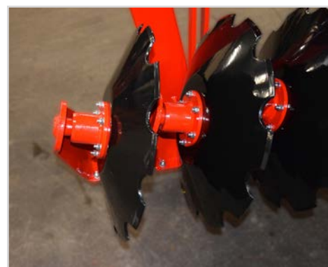
Ø610x6 mm disc med grov skæreprøfil
