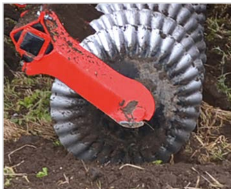
Ø570 x 6 mm profilierte Mischscheibe
