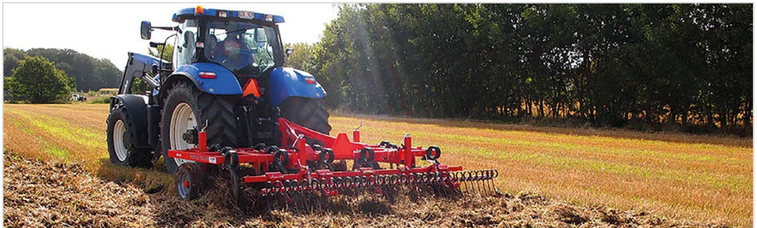
4,00 m Triple-Tiller Airy avec dents à ressort.
