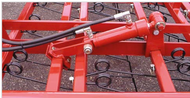
Hydraulisk indstilleligt tandtryk
