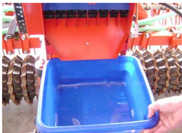
5. Placer kalibreringsbeholder under indsåningstragt
