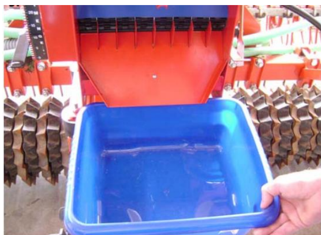
5. Placera behållaren under vridprovstratten
