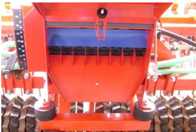
4. Montera vridprovstratten under doseringvalsen
