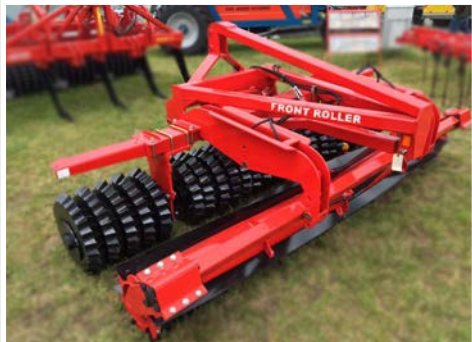
Die 1-teiligen Front-Roller-Modelle sind in den Arbeitsbreiten von 1,50 m bis 4,00 m erhältlich.
