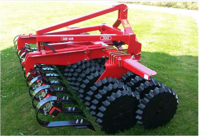
Front-Roller Twin in 3 m Arbeitsbreite mit 550/550 mm Sternringen aus Stahlguss und Spring-Board (auch erhältlich mit 450/450 mm Sternringen).
