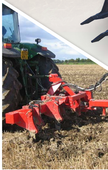
Le Combi-Tiller MKI est monté sur les bras de levage du tracteur pour travailler seul ou avec un outil remorqué.
