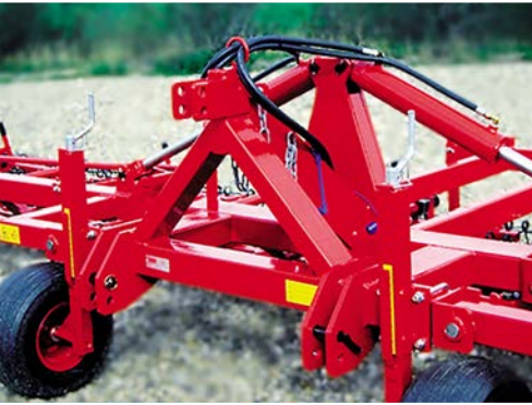
Attelage sur 12,00 et 15,00 m. Châssis fixe renforcé.
