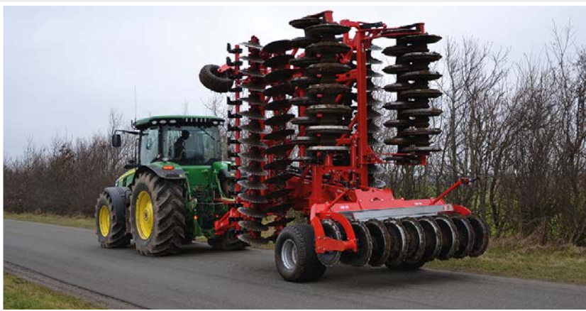
Disc-Roller XL Contour avec disques crénelés 2-sections et rouleau V-profil 3-sections en position transport (6,50 + 7,50 m)
