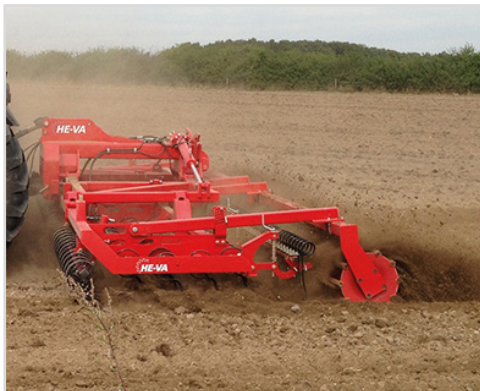
7,50 m lyftburen Terra-Dan MKII med rörvals med fyrkantsrör.
