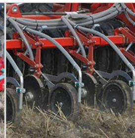
Semis av/disques semeurs av/roues de profondeur (packer) larges de 75 mm. Semis 1 sillon/dent derrière le rouleau packer
