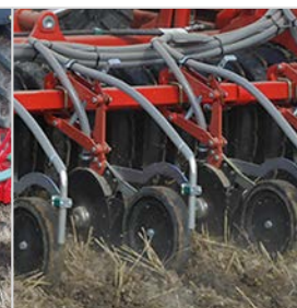
Aussaat mit Scheibenscharen mit 75 mm breitem Tiefenrad / Packerrad. Platziert in einer Reihe pro Zinke nach der Packerwalze.
