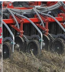
Skiveskærs-såning med 75mm brede dybdehjul / pakkervalse. Placeret i 1 række pr. tand efter pakkervalse.
