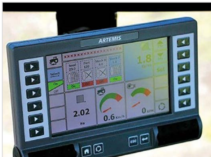
HE-VA Terminal: Pour contrôle Multi-Seeder Twin et sur machines avec 2 à 3 trémies de semences.
