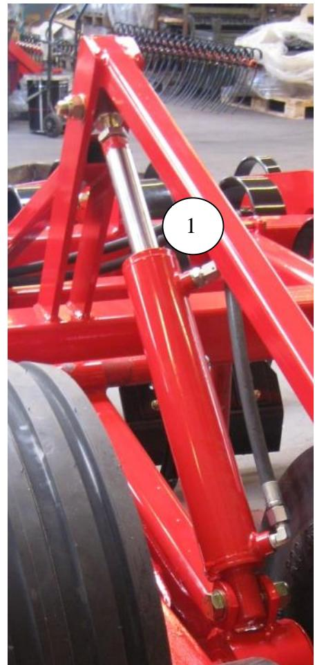
kolvstångsändarna på mastercylindern mer än 30mm eller mer en 50mm på slavcylindrarna. Kom ihåg att skruva åt stoppmuttrarna på kolvstångshuvudena.
