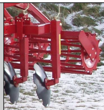
Disque de bordure avec réglage par manivelle et repliage manuel.
