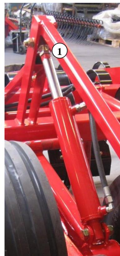
Ne **jamais** retirer au-delà de 30 mm le bout de la tige du vérin maître (50 mm sur les vérins asservis). Veiller à serrer les contre-écrous.
