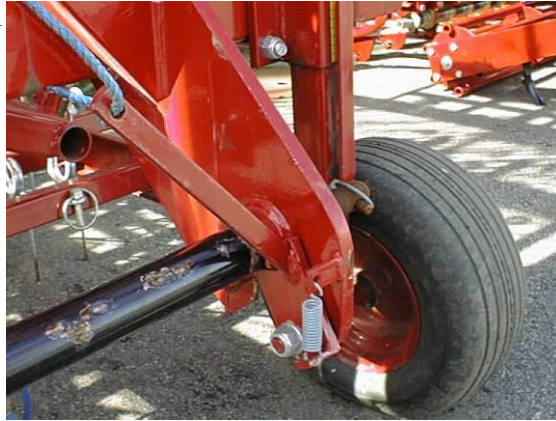
Hurtigtilkobling på 6,0 og 7,5m. Quick-coupling on the 6,0 and 7,5m.
