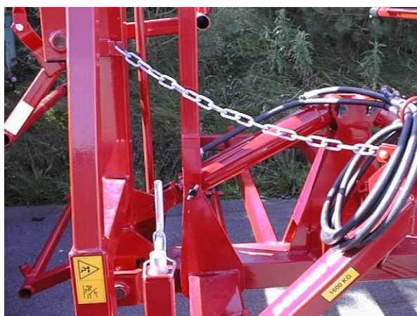
Sikkerhedskæde til transportsikring af vinge. Securitychain for sideframe.
