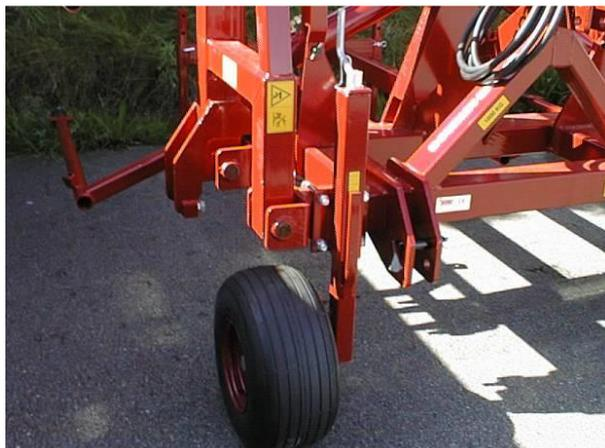
Ajuster les roues porteuses jusqu'à ce que le bâti herse soit horizontal. Verrouiller la broche
