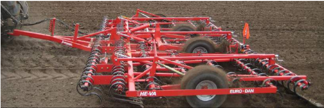
Euro-Dan Eco 8,00 m mit robuster Frontegge, Spring-Board-Schiene mit Schleppzinken und Spring-Board-Striegel.
