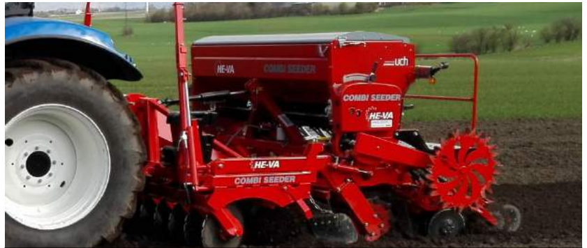
3,00 m Disc-Seeder m/Schwerer Rohrwalze und Scheibenscharen
