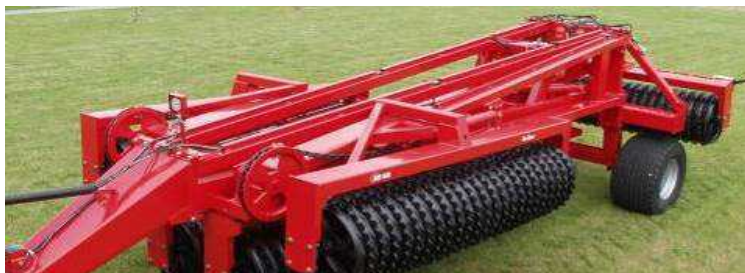
King-Roller 15,30 m. monteret med 620mm/24" Cambridgeringe.
