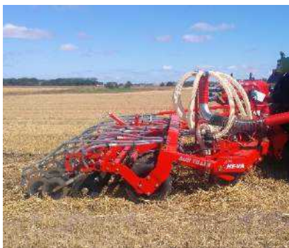
4,00 m Sub-Tiller m/hydr. sammenklap, 7 tænder, m/V-profilringe og Quick-Push stensikring.
