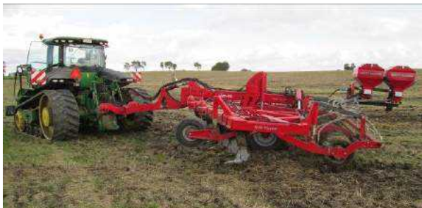
7,00 m med hydr sammenklap, 13 tænder, m/ V-profilringe, hydr. automatudløser.
