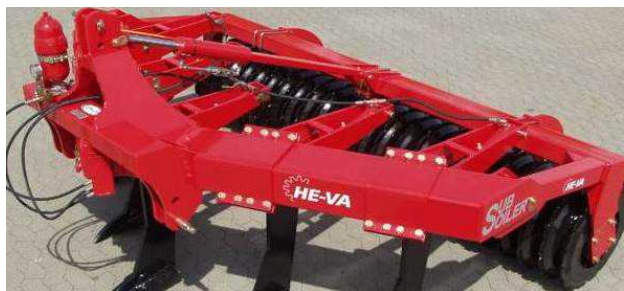
3,00 m Sub-Tiller fast, med 5 tænder, med V-profilringe, hydr. automatudløser.
