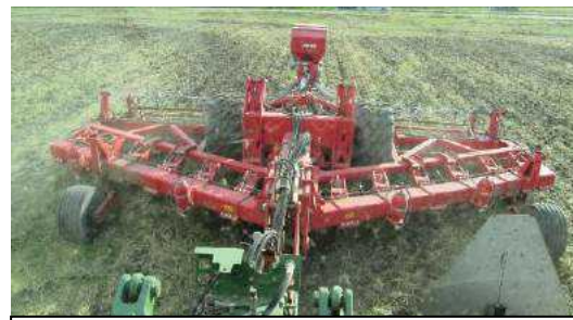
7,00 m m/hydr. sammenklap, 13 tænder, m/V-profilringe og hydr. automatudløser
