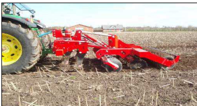
Combi-Disc med grubbertænderne løftet fri af jorden, og dermed er kun Disc-Roller funktionen i arbejde.
