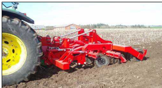
Combi-Disc med tænderne i fuld arbejdsdybde. Dermed opnås grubning, kultivering og pakning.
