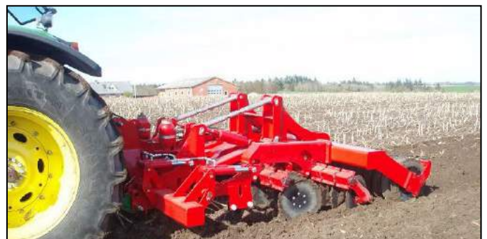
Combi-Disc mit den Zinken in max. Arbeitstiefe, gewährleistet Tiefenlockern, Kultivierung und Rückverfestigung.
