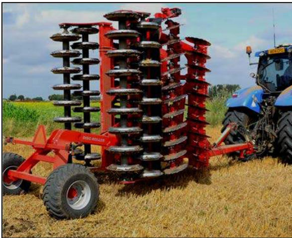
3,50 m Disc-Roller Contour aufgesetzt m/Twin V-Profilwalze und Spring-Board
