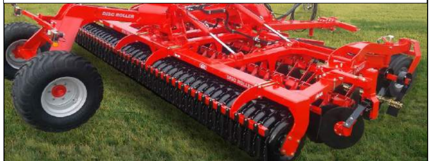
6,50 m Disc-Roller Contour Spritztuch für das Material, lenkbaren Stützrädern und Pendelzug.
