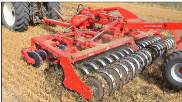
5,50 m Disc-Roller Contour m/Twin V-Profilwalze und Spritztuch für das Material.
