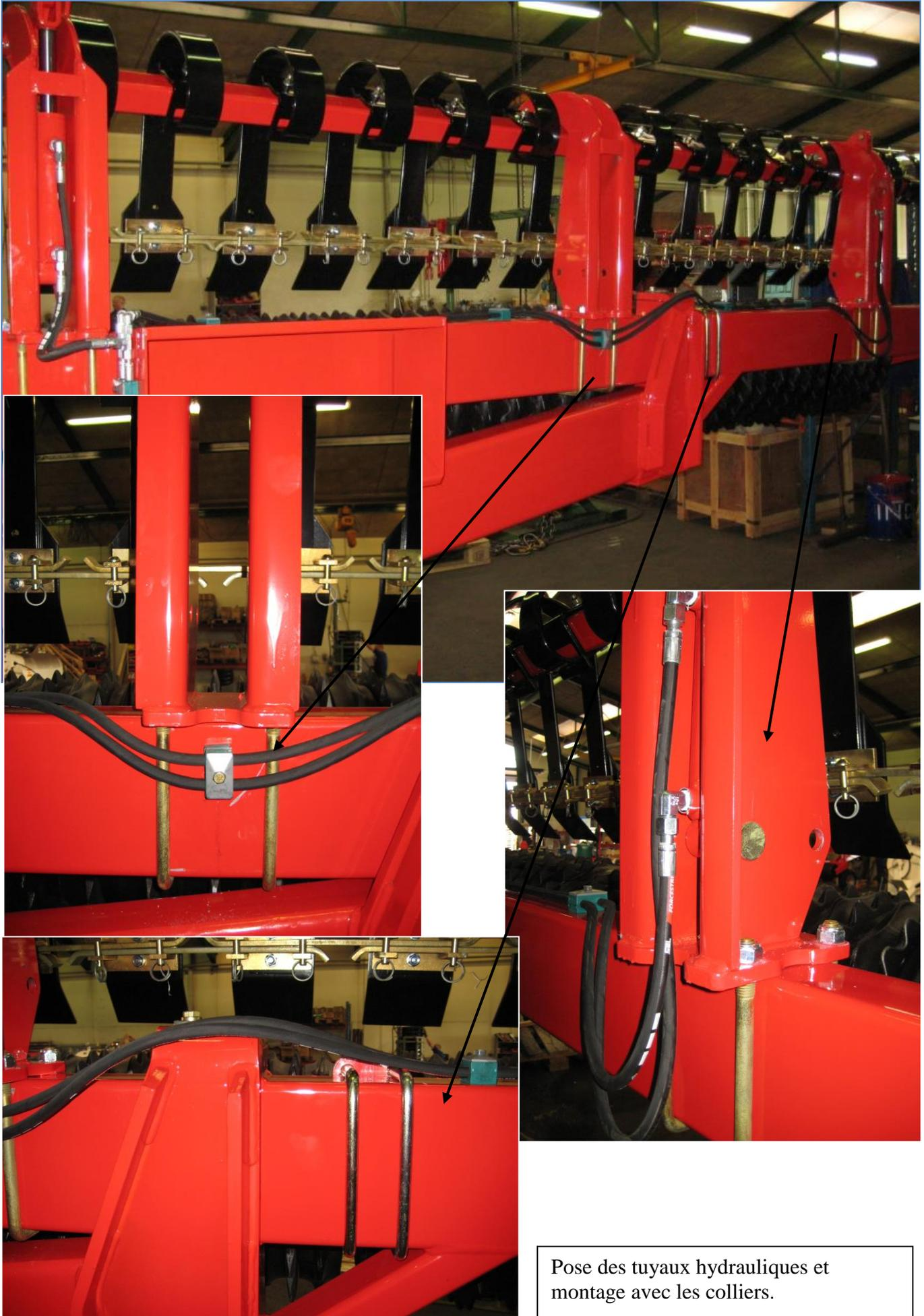
Pose des tuyaux hydrauliques et montage avec les colliers.
