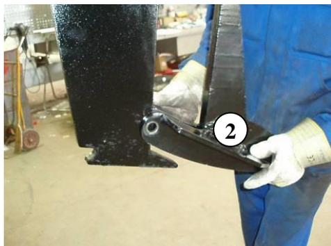
1. ⚠ Vor der Arbeit mit den Verschleißspitzen der Maschine, ist die Maschine zu befestigen. Dies kann durch Böcke unter dem Hauptrahmen oder dadurch ausgeführt werden, die Walze zu stützen.
