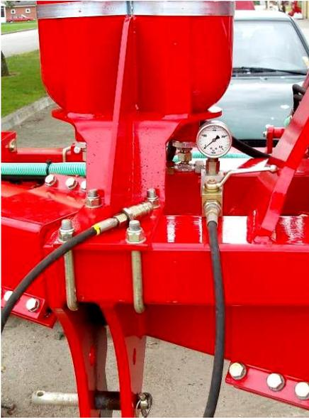
1. Avant la saison vérifier que la pression des accumulateurs (Pos.1) est à 110 bar. ⚠ Des outils spéciaux sont nécessaires, et l'action doit être exécuté par un concessionnaire autorisé.
