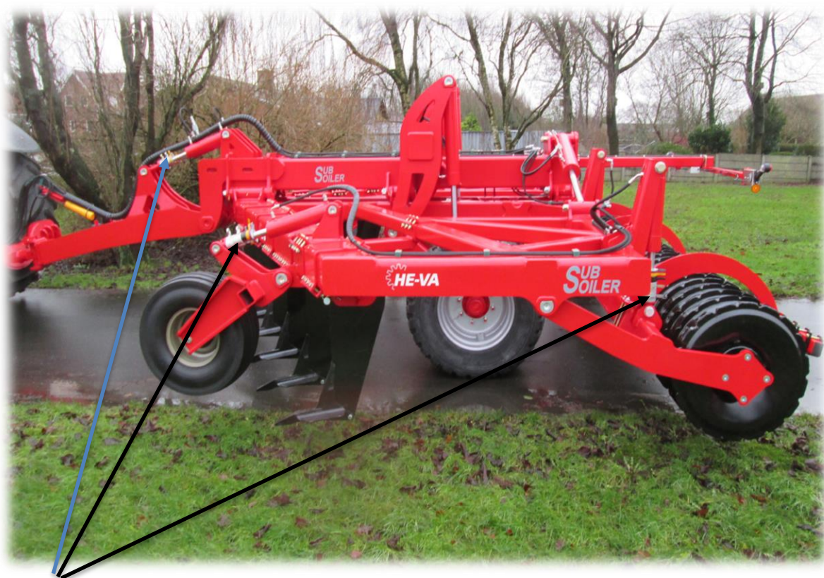
Billede 7. Arbejdsdybden justeres med clips.
