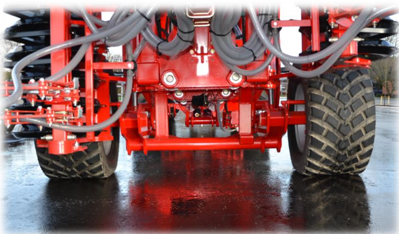
Billede 2. Transportben hviler på hjulstel.
