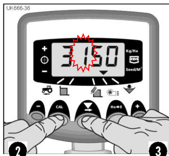
Figur 20: Alarmgrænse for lav blæserhastighed.
