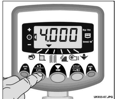
Abbildung 12: Anzeigen der Arbeitsbreite
