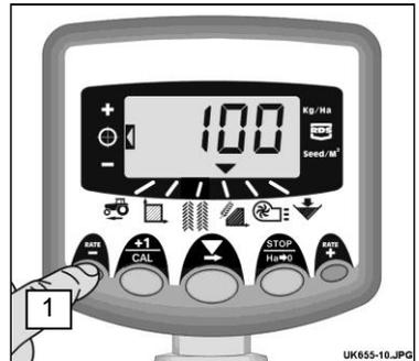
Abbildung 15 : Anzeigen der aktuellen Aussaatmenge
