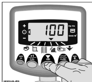
Abbildung 14 : Anzeigen der Aussaatmenge
