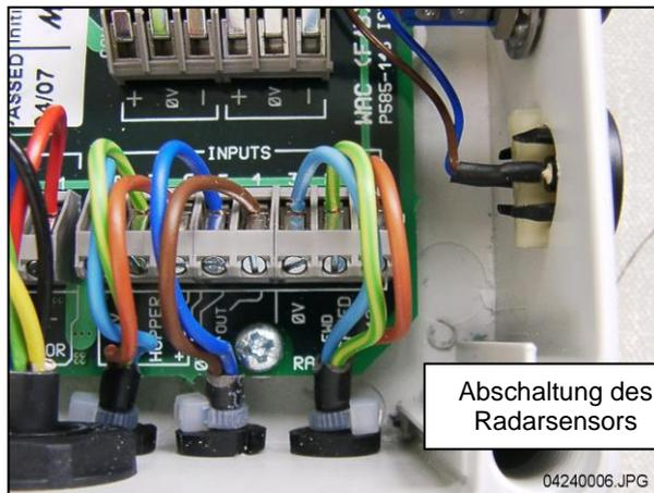
Das Verlängerungskabel an Radarsensor einschalten und es zurück an der Anschlußdose zurückführen. Die existierenden Verkabelungen folgen, wo es möglich ist, und das Kabel mit den gelieferten Klemmen befestigen.
