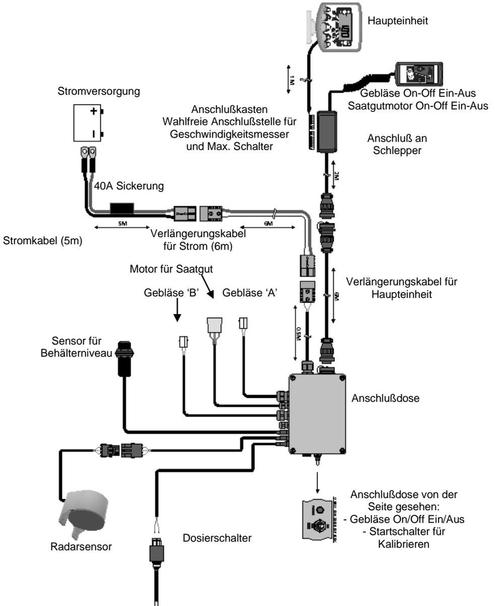
Die meisten Komponenten für HE-VA Auto-Controller sind im Werk montiert. Die übrigen Komponenten werden bei dem Kunden montiert:
