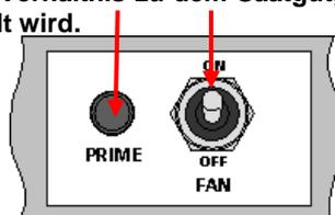
2. Trichter und Trog für Kalibrieren des Multi-Seeder unter der Dosierwalze montieren. Die Taste PRIME drücken, bis das Saatgut herauskommt.
