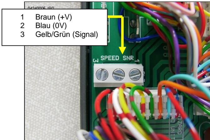
Grundeinstellung für Sensor (SSF) = '7.78' (mm/Impuls). Dies ist die theoretisch korrekte Einstellung, wenn der Radarsensor in genau dem richtigen Winkel im Verhältnis zu dem Boden installiert ist. Jedoch ist der Winkel oft nicht ganz präzise, und für ein präzises und genaues Geschwindigkeitsmessen, ist es empfehlenswert, den Kalibrieren-Wert durch eine Durchführung von einer automatischen Einstellung des Gerätes zu kontrollieren (siehe Kapitel 4.4)
