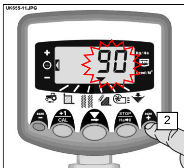
Figur 16: Indställ önskad utsädemängd
