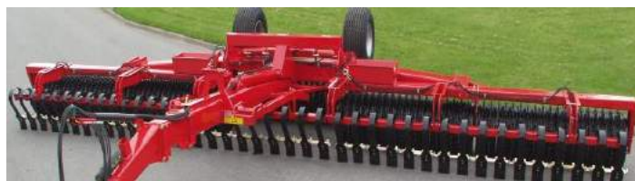
10,20 m. Tip-Roller mit 620 mm/24" Cambridge, Spring-Board & Querverriegelung.
