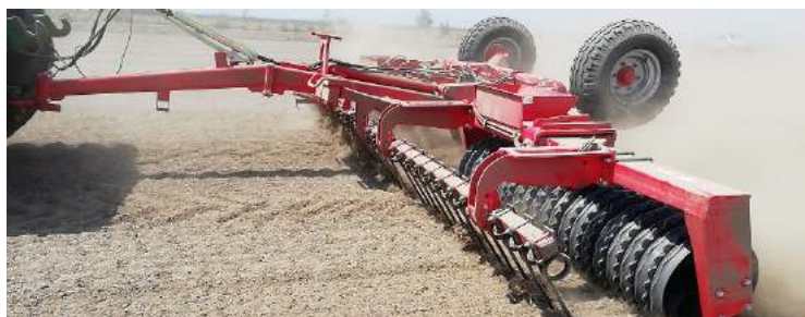
10,20 m. Tip-Roller mit 620 mm/24" Cambridge, Spring-Board & Querverriegelung.
