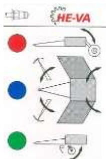
Indikationsmærkat for maskinens hydrauliksystemer.
