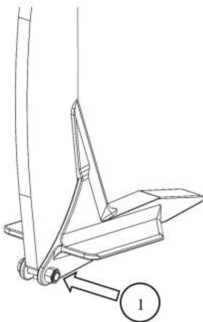
⚠ Før der arbejdes med maskinens slidspidser, skal maskinen sikres. Dette kan gøres med bukke under hoved rammen.
