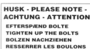
Efterspænd alle bolte efter kort tids brug. Hvis dette ikke overholdes, bortfalder vore garantiforpligtelser.
