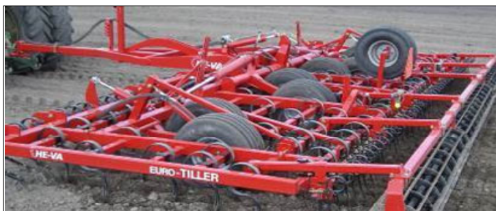
8,00 m Euro-Tiller m/Spring-Board planerplanke, fladjernsvalse inkl. langfingerefterharve og reservehjul
