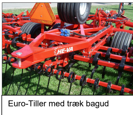
Dolly: Hjul sæt, der muliggør tilkobling af tromle bag harven – 11,5/80 x 15,3 hjul
