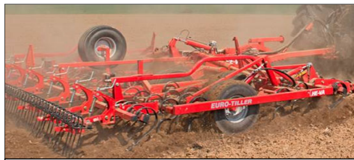
6,00 m Euro-Tiller m/ förharv, Spring-Board fjäderpinnsplanka, Spring-Board efterharv, långfinger-efterharv och reservhjul.
