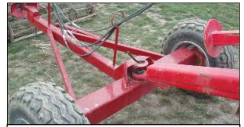
Dolly: hjulsätt som möjliggör tillkoppling av vält efter harven - 11,5/80 x 15,3 hjul.
