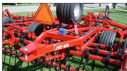
Euro-Tiller med drag för t.ex ringvält.
