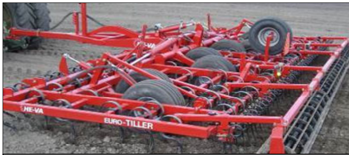
8,00 m Euro-Tiller m/ Spring-Board plank, vals inkl. långfinger-efterharv och reservhjul.
