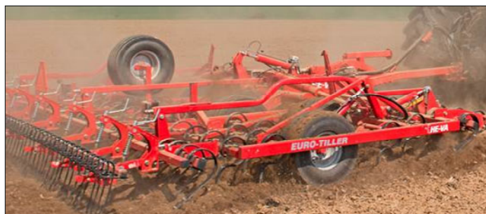
Euro-Tiller 6,00 m avec rangée de dents efface traces, Spring-Board frontale à lames de ressort, Spring-Board arrière, herse peigne arrière et roue de secours.
